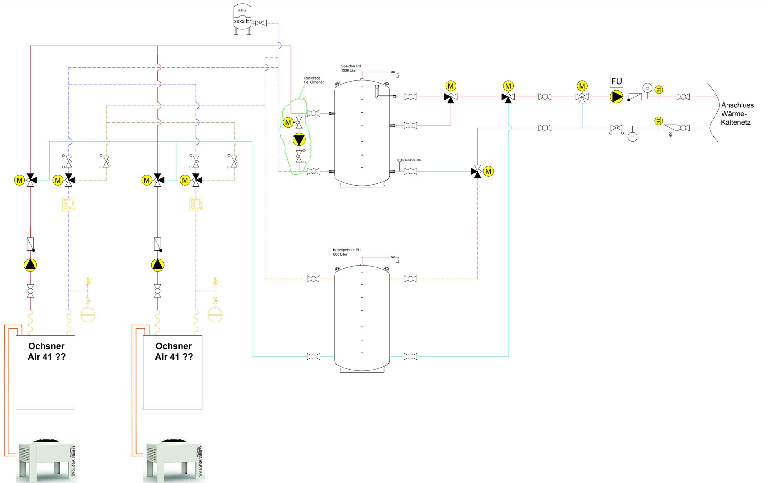
Hydraulikschema. Kein Anspruch auf Vollständigkeit und Richtigkeit.
